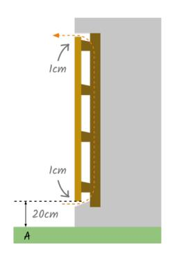
Es wird empfohlen, einen Herz-an-Herz-Abstand von 40cmeinzuhalten. Bringen Siebei Treffpunkten (siehe Punkt B) in Längsrichtung eine breitere oder zwei zusätzliche Unterkonstruktionsleisten an.
